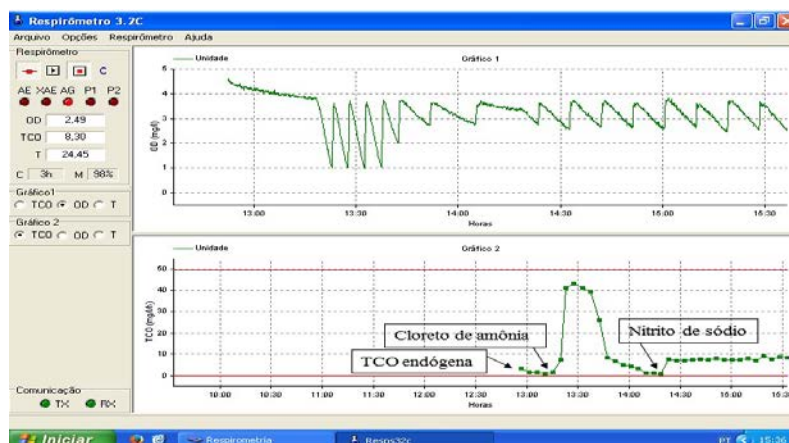
Figura 5. Respirograma com adição dos substratos para bactérias nitrificantes no licor misto do RBS.
